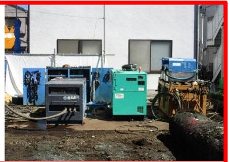
回転力発生油圧装置、水圧発生装置
